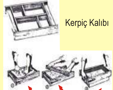
Kerpiçin kalıba yerleştirilmesi, yüzeyinin düzeltilmesi ve kalıptan çıkarılması.
